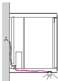
Per utilizzare l'illuminazione del pensile è indispensabile predisporre l'uscita dei cavi di alimentazione entro il perimetro del pensile stesso. Le lampade sono dotate di alimentatore. L'elettrificazione è completamente nascosta all'interno del pensile.
