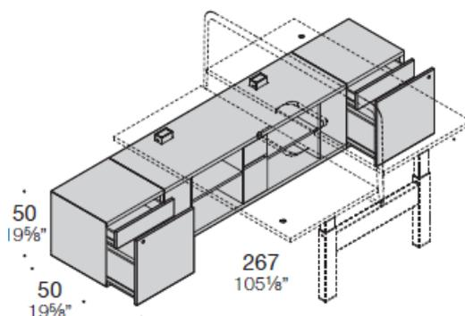
Evolution 50 - Contenitore base terminale per bench con aassetto interno e cestone portatile
